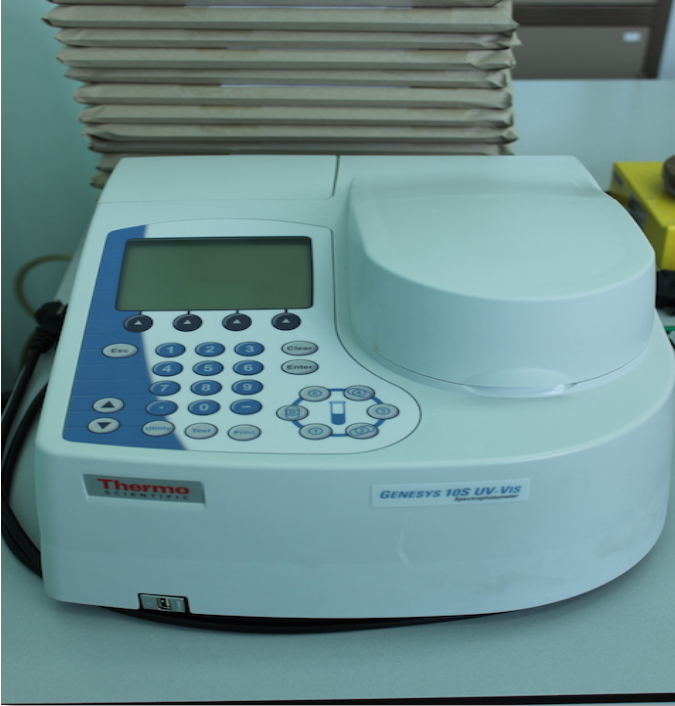
Şekil 3.15. Askorbik asit ölçümünde kullanılan Spektrofotometre
