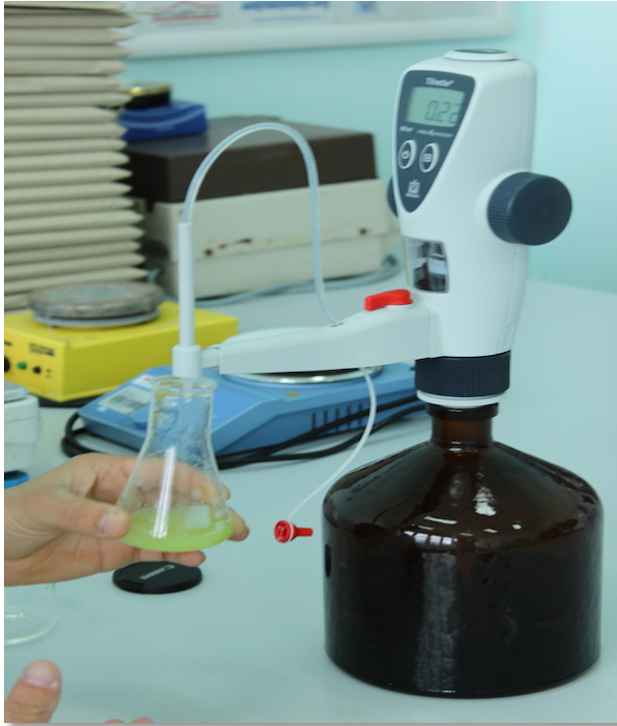
Şekil 3.14. Titrasyon işleminde kullanılan dijital büret
