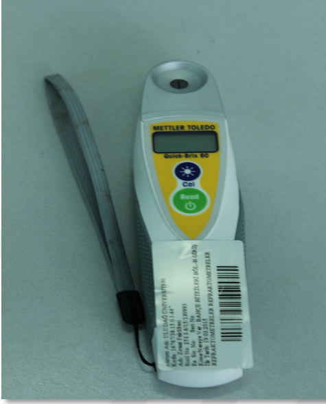
Şekil 3.12. SÇKM ölçümlerinde kullanılan dijital el refraktometresi
