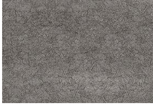
Şekil 2.15. Martenzitik paslanmaz çelik mikro yapısı (Anonim 2019)
