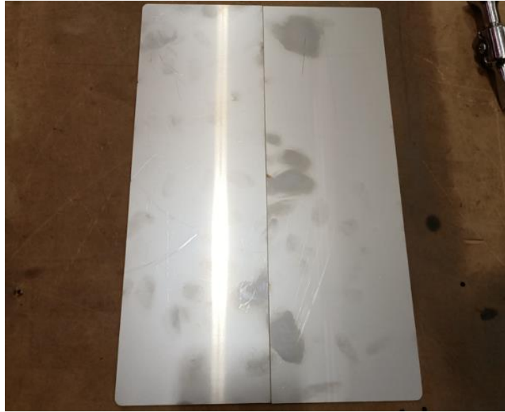
Şekil 3.1. Kaynatılacak parçaların hazırlanması
