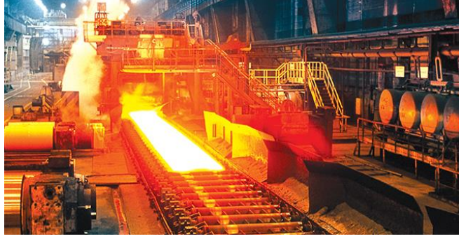
Şekil 2.9. Sürekli döküm örneği (Anonim 2016)
