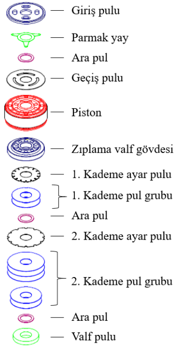
Şekil 3.22. Piston valf grubu parçaları
