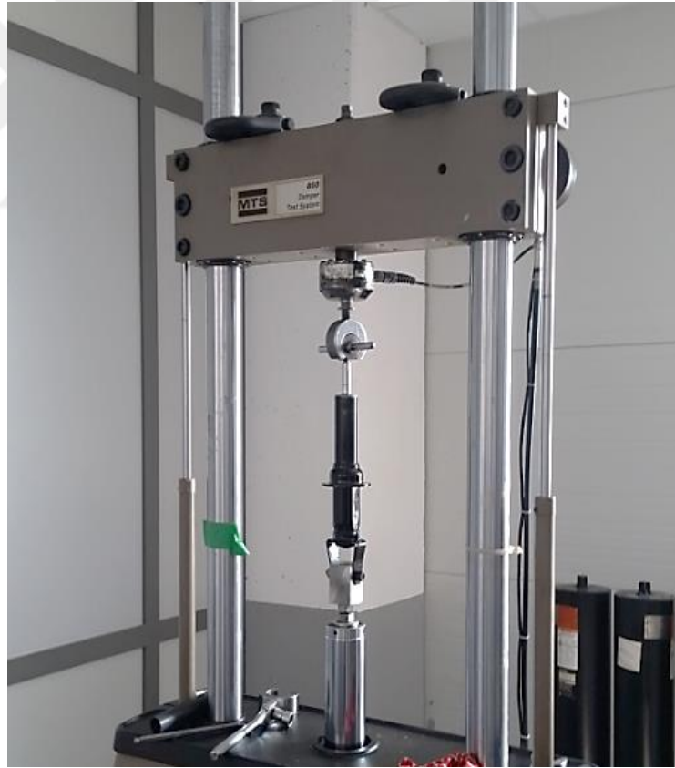
Şekil 3.30. MTS servo-hidrolik performans test makinesi
