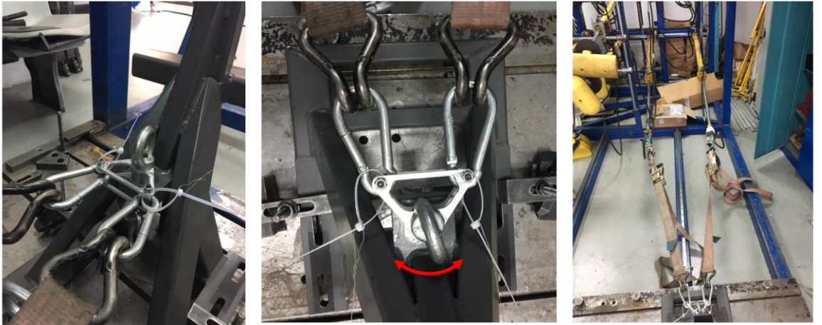
Şekil 4.2. Araç yönlendirme krankının fiziksel yükleme testi yapılışı
