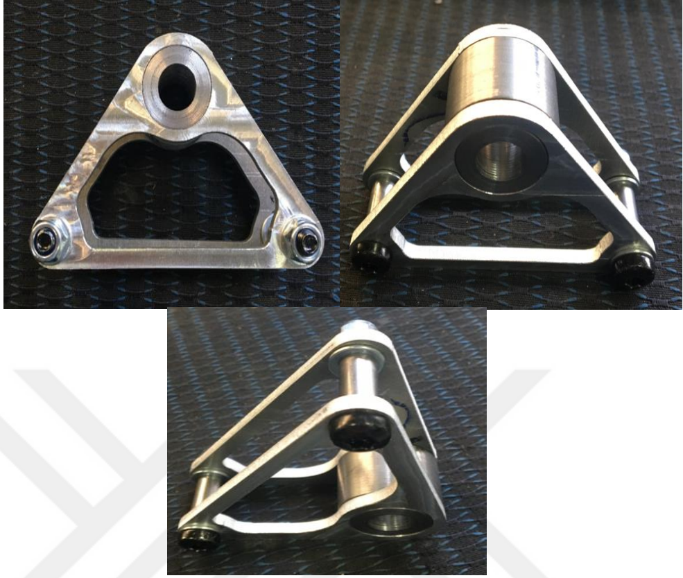
Şekil 4.1. Tasarımın 7000 seri Alüminyum ile üretilmiş numunesi
