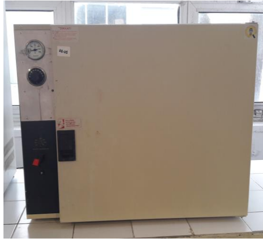
Şekil 3.3. Sulu H 2 SO 4 çözeltilerinin PAN nanoliflere döküldükten sonra fırınlanmasında kullanılan fırının fotoğrafı.
