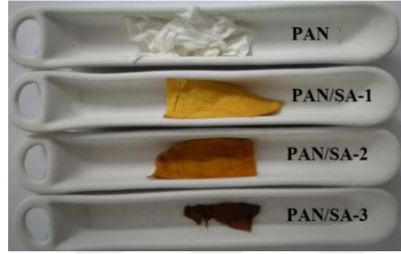
Şekil 4.13. 180°C'de 1 saat fırınlanmış PAN ve farklı miktarlarda H 2 SO 4 katkılı PAN nanoliflerin fotoğraf görüntüleri.
