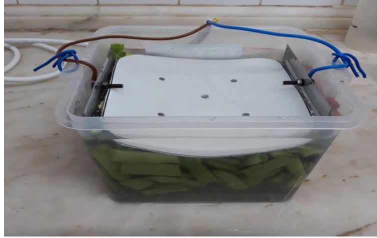
Şekil 3.2. Üretimde kullanılan ohmik ısıtma sistemi
