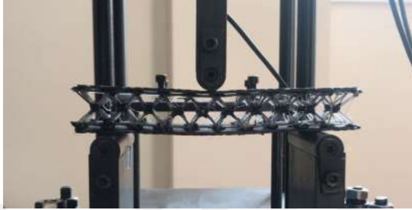
Şekil 4.8. Üç nokta eğilme test düzeneğinin görünümü
