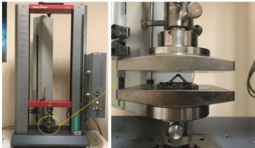
Şekil 4.2. Zwick Roell Z010 Basma testi makinesi ve teste hazır numunenin çeneler arasındaki görüntüsü
