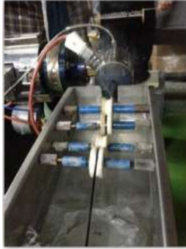
Şekil 3.2. Termoplastik karbon fiber filament yapının kalıptan çıkışı (Güçlü ve ark. 2018)
