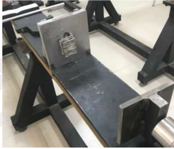
Şekil 3.21. Yüksek hızlı darbe testinde numunenin duvara sabitlenmiş görüntüsü
