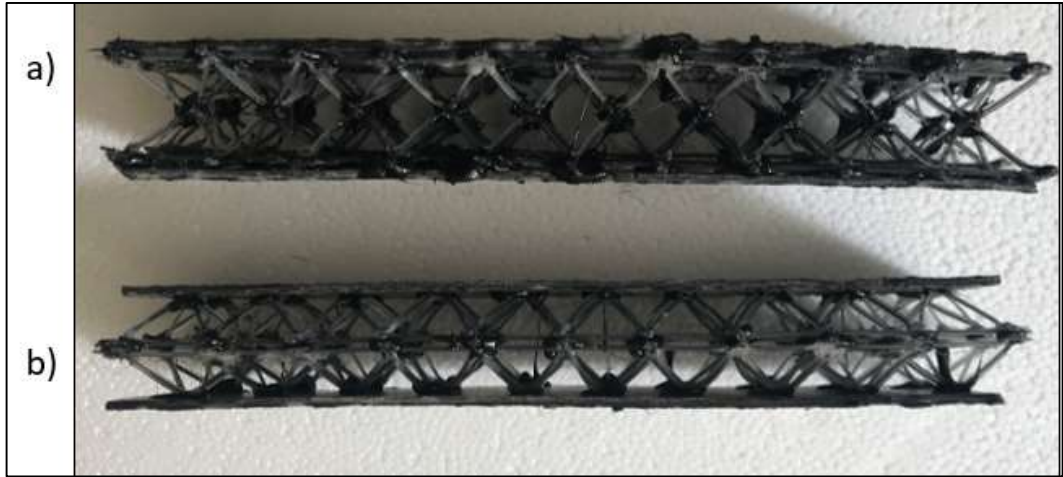
Şekil 3.16. a) Uç uca , b) taban tabana ekleme metoduyla üretilmiş sandviç plakalar
