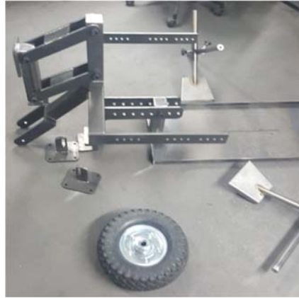
Şekil 3.4. Dört kol mekanizması imalat resmi
