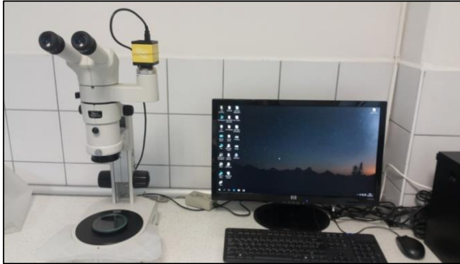
Şekil4.4. SMZ800N model mikroskop
