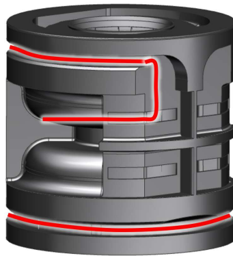
Şekil 3.21 Hidroburç içindeki akışkanın normal yüklerdeki rotası
