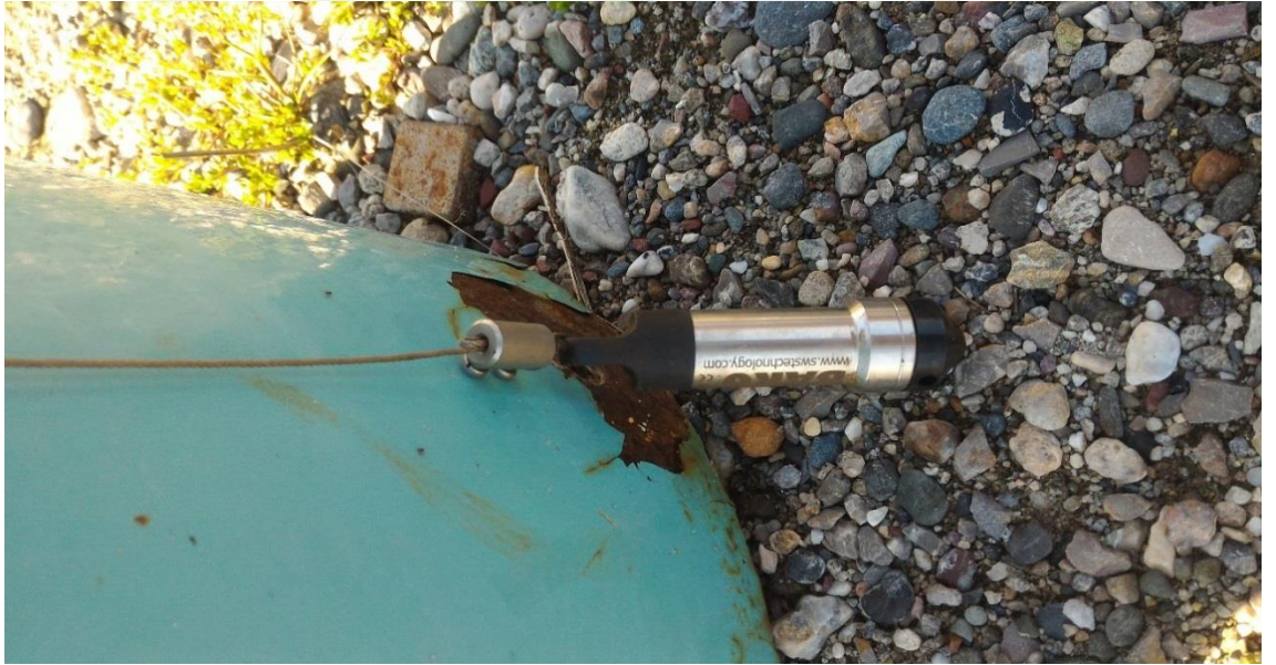
Şekil 3.3. Mini-Diver cihazından verilerin aktarılması
