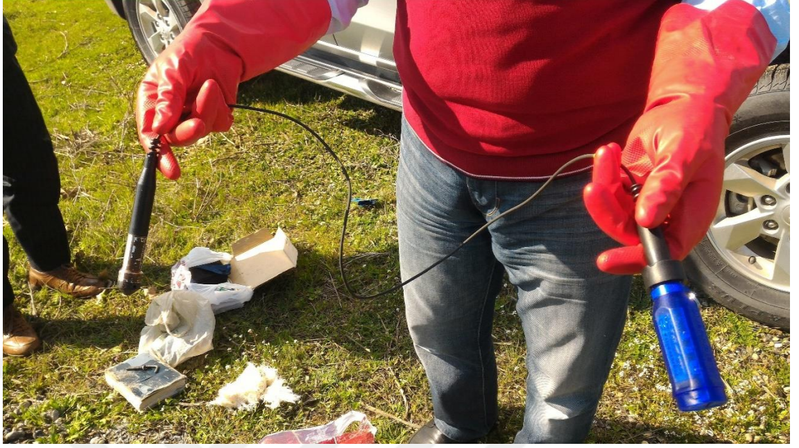
Şekil 3.3. Mini-Diver cihazından verilerin aktarılması
