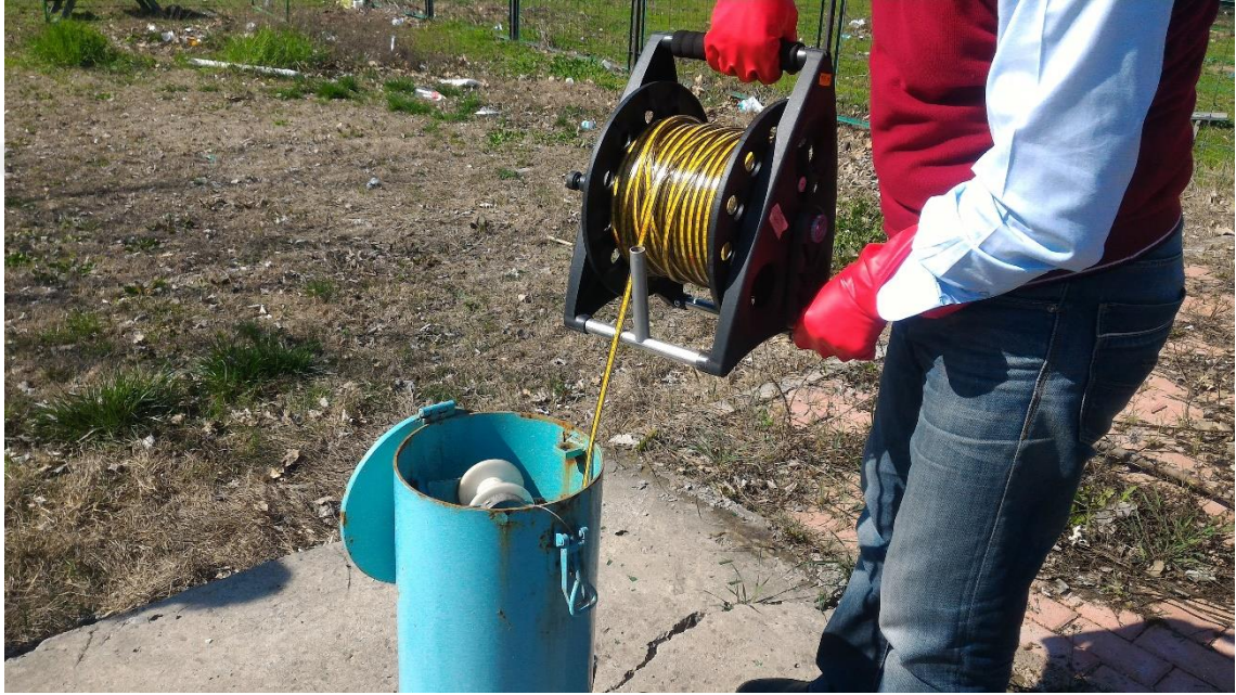
Şekil 3.5. Seviyemetre cihazı ile yapılan manuel ölçümler
