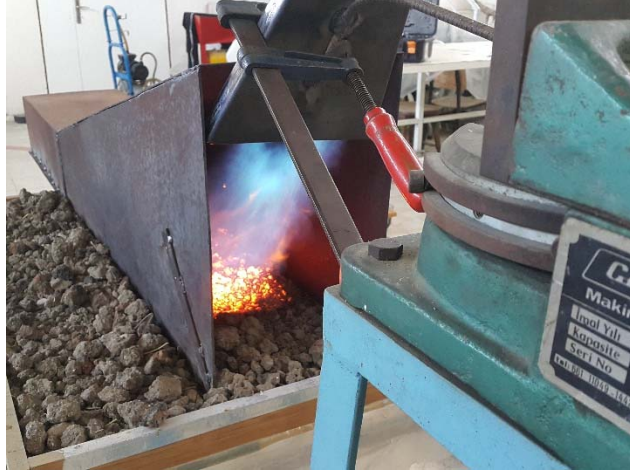
Şekil 3.1. Atölye koşullarında LPG emisyon ölçümleri için geliştirilen sistem
