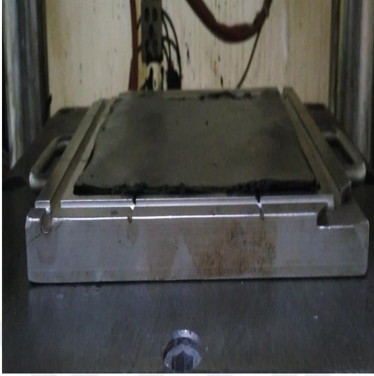
Şekil 3. 10. Kauçuk hamurun vulkanizasyon kalıbına yerleştirilmesi
