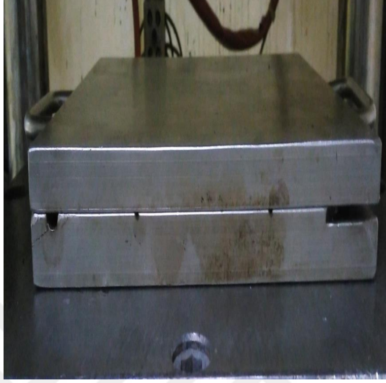
Şekil 3. 9. Kalıp ayırıcı uygulanan plakaların vulkanizasyon presine krlenme iin yerleřtirilmesi
