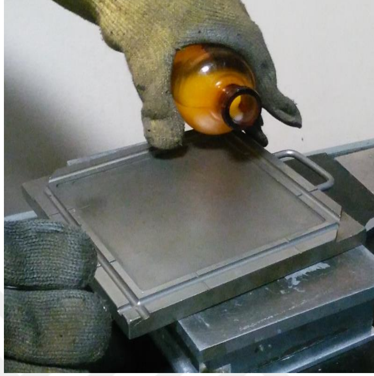
Şekil 3. 8. Kalıp plakasına kalıp ayırıcı dökülmesi
