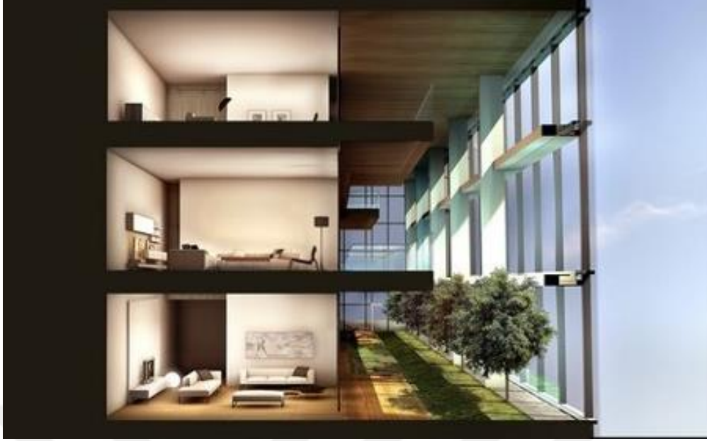
Şekil 3.14. Çift cephe kabuk sistem detayı ( http://www.yapi.com.tr/Uploads/HaberMedya/2008/haber_dosyaları/mimarlikta_ekoloji/Tabanlıoğlu_sapphire2.JPG ) (05.07.2019)
