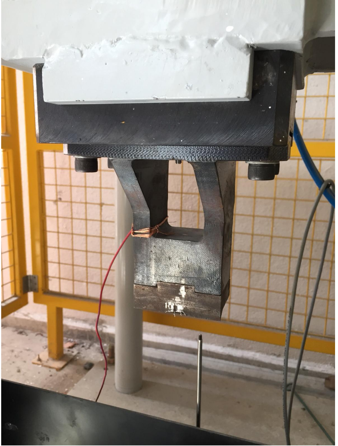
Şekil 3.11. Kırıcı uç imal edilmiş hali
