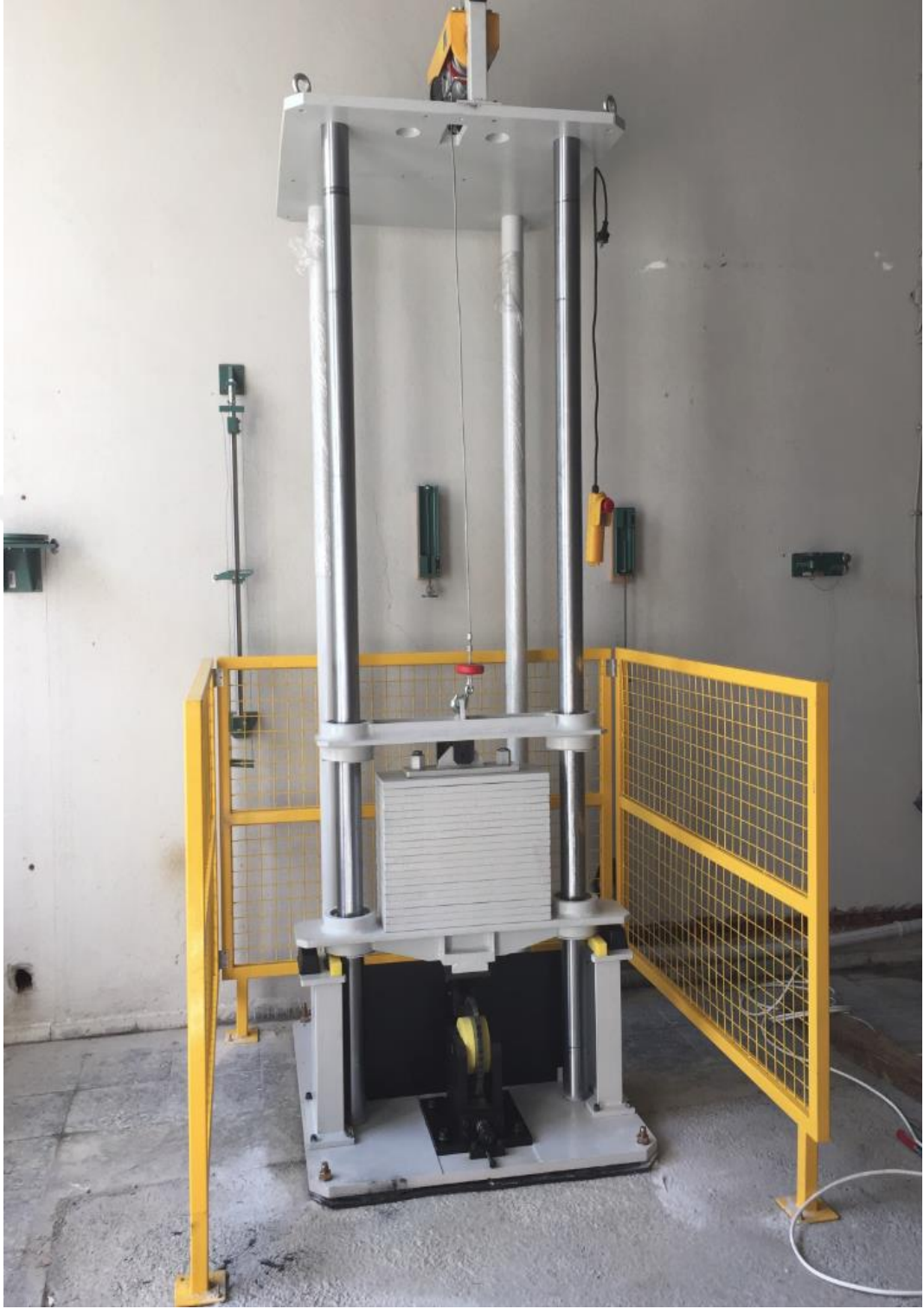
Şekil 3.6. Dişli darbe test cihazı imal edilmiş hali
