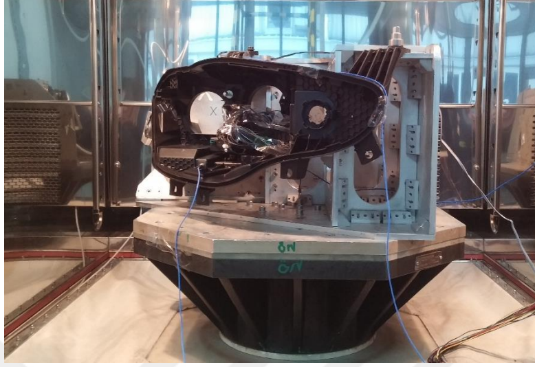
Şekil 3.2. Klimatik kabinli sarsıcı, test fikstürü ve aydınlatma elemanı
