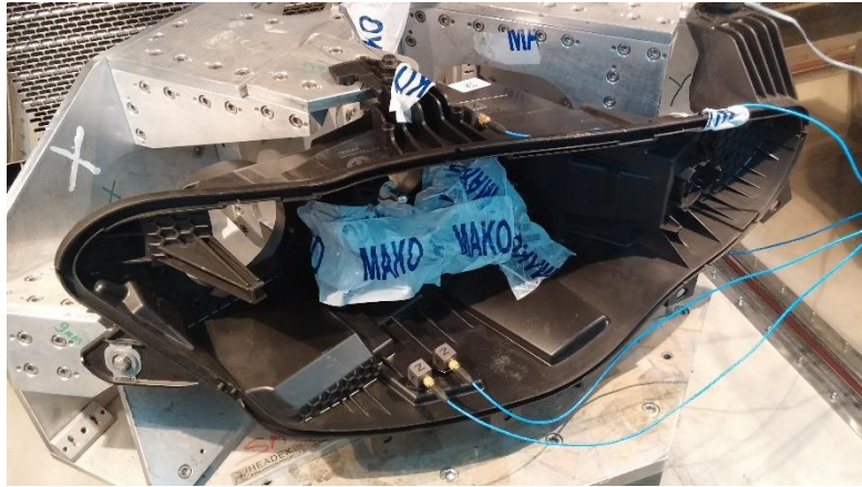
Şekil 3.4. Parça üzerine yerleştirilen ivme ölçerler
