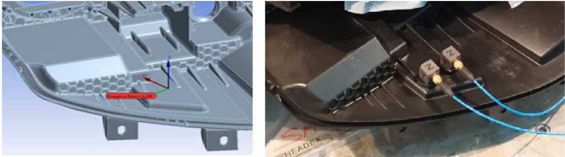
Şekil 4.12. İvme frekans cevabı ölçülen nokta
