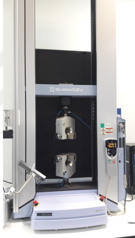
Şekil 3.12. Kumaş mukavemetinin ölçüldüğü cihaz: Shimadzu Autograph AG-X plus
