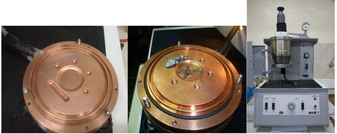
Şekil 3.1. Saf alařım elementlerinin yerleřtirildięi bakır tabla ve ark eritme cihazı.
