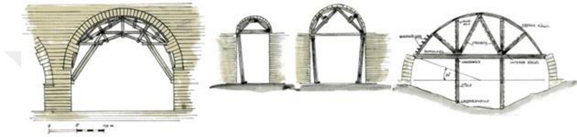
Şekil 3.41. Taşıyıcı iskele yapımı (Barow 2013)
