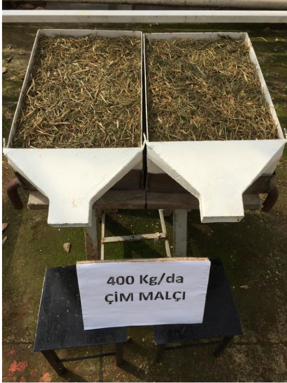
Şekil 3.6. Çim kırıntısı malçı uygulanmış (a, b, c, d, e, f) ve yapay yağış uygulanmasına hazırlanmış erozyon parselleri (devam).
