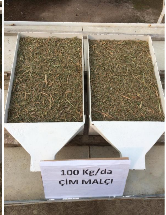
Şekil 3.6. Çim kırıntısı malçı uygulanmış (a, b, c, d, e, f) ve yapay yağış uygulanmasına hazırlanmış erozyon parselleri.
