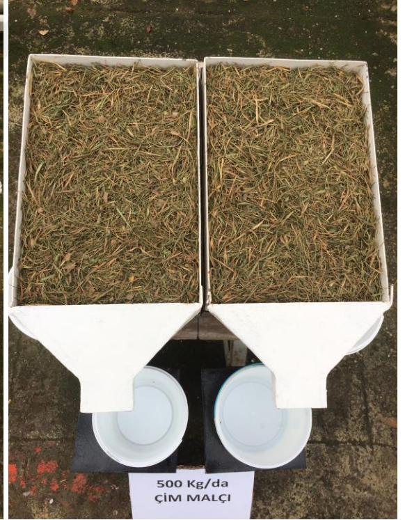
Şekil 3.6. Çim kırıntısı malçı uygulanmış (a, b, c, d, e, f) ve yapay yağış uygulanmasına hazırlanmış erozyon parselleri (devam).
