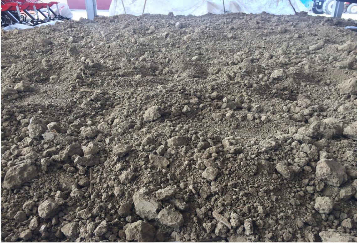
Şekil 3.2. Atmosfer koşulları altında gölgede kurumaya bırakılan toprak örneği.
