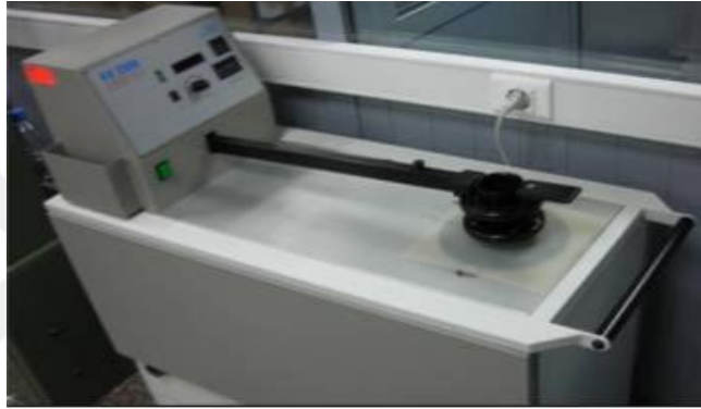
Şekil 2.2. Hava Geçirgenliği Test Cihazı (Anonim 2019)
