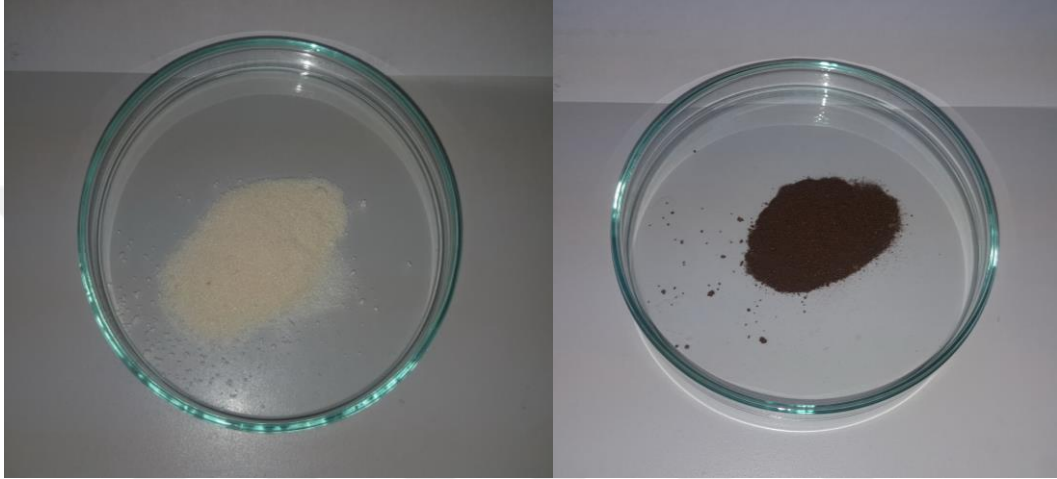
Şekil 3.11. Polimer mikro kürelerinin fotoğrafı (a) poli (DVB-VIM) (b) m-poli(DVB-VIM)
