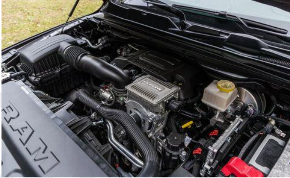
Şekil 3.17. 2019 model Ram 1500 eTorque kamyonetinin içten yanmalı ve elektrikli motorları
