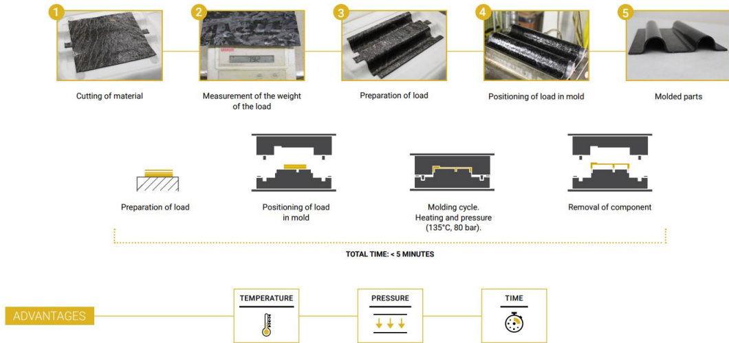
Şekil 3.37. Forged Composites şekillendirme adımları (Anonim, 2017a)
