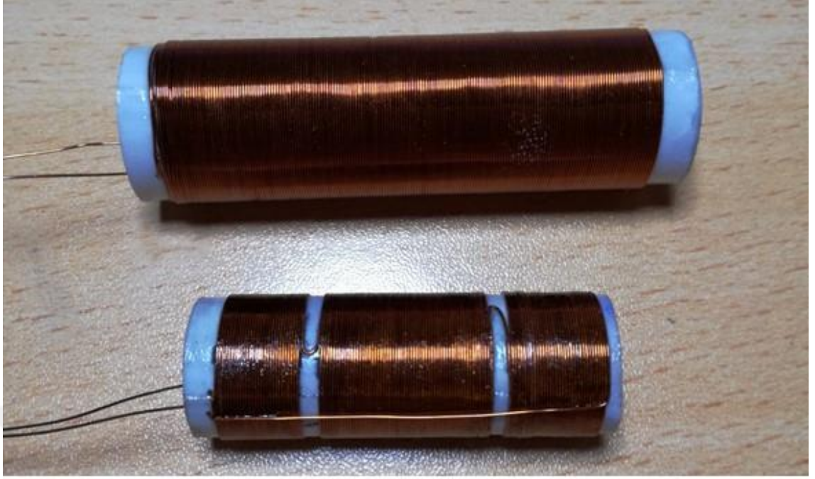
Şekil 3.7. Bobin sistemi. Uyarıcı/sürücü bobin üstte, algılayıcı bobin alttakidir
