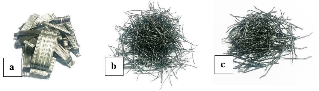
Şekil 3.1. İki ucu kancalı çelik lifler; a. En boy oranı 54; b. En boy oranı 64; c. En boy oranı 50
