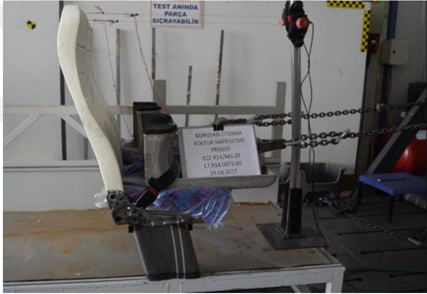
Şekil 2.6 ECE-R14 Çekme testi örneği
