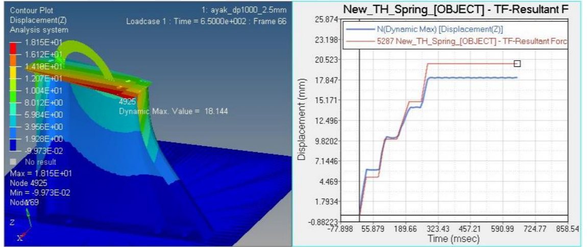
Şekil 4.28. DP1000 – 2,5 mm ayak için kuvvet-yer değişimi-zaman grafiği
