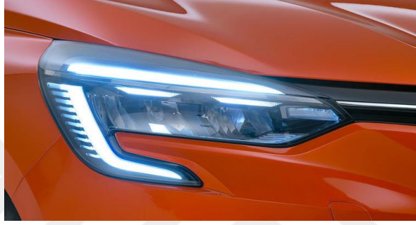
Şekil 2.7. Renault Clio Full LED uygulaması
