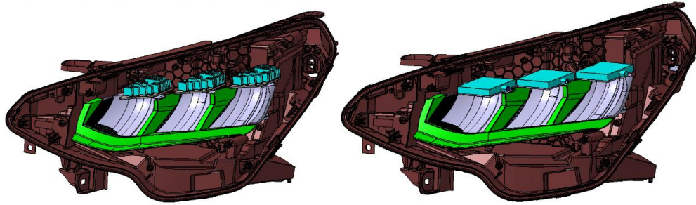
Şekil 4.43. Ön aydınlatma elemanı üç boyutlu modeli a) Kanatçıklı soğutma b) Sıvı soğutma
