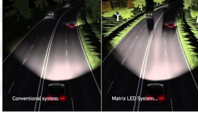
Şekil 2.6. Matrix far ve konvansiyonel far karşılaştırılması
