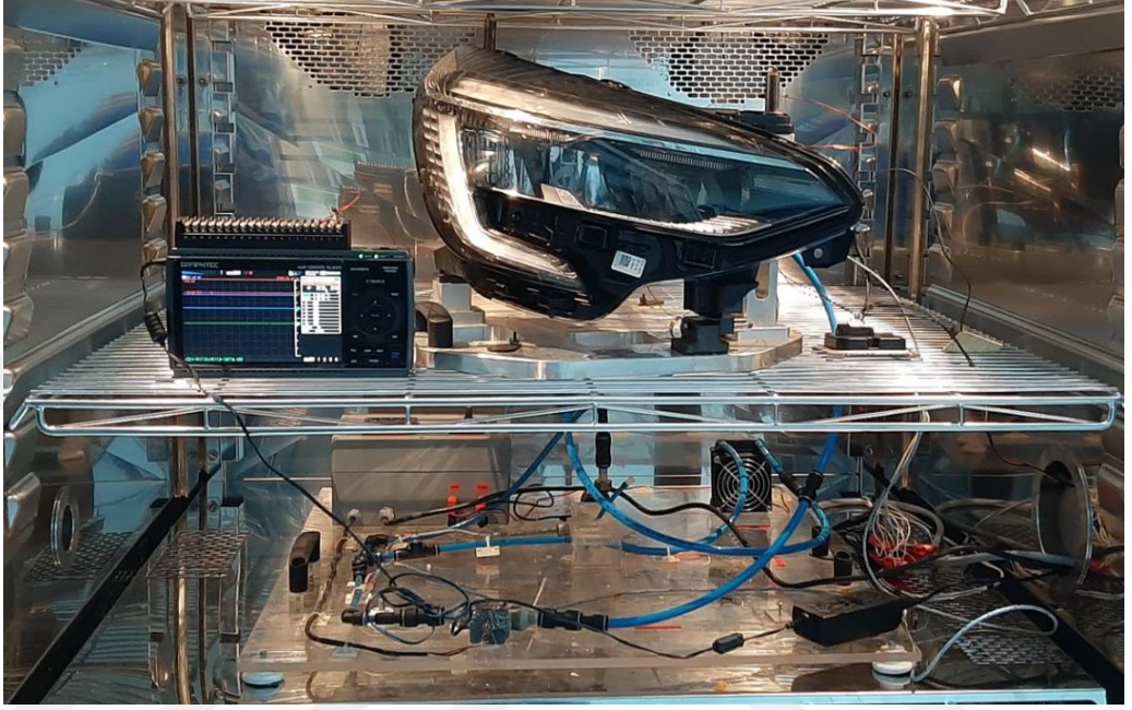
Şekil 3.33. Ön aydınlatma elemanı test düzeneği
