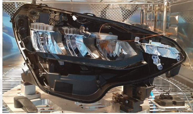
Şekil 3.31. Soğutucu blok tasarımının ön aydınlatma elemanında konumlandırılması
