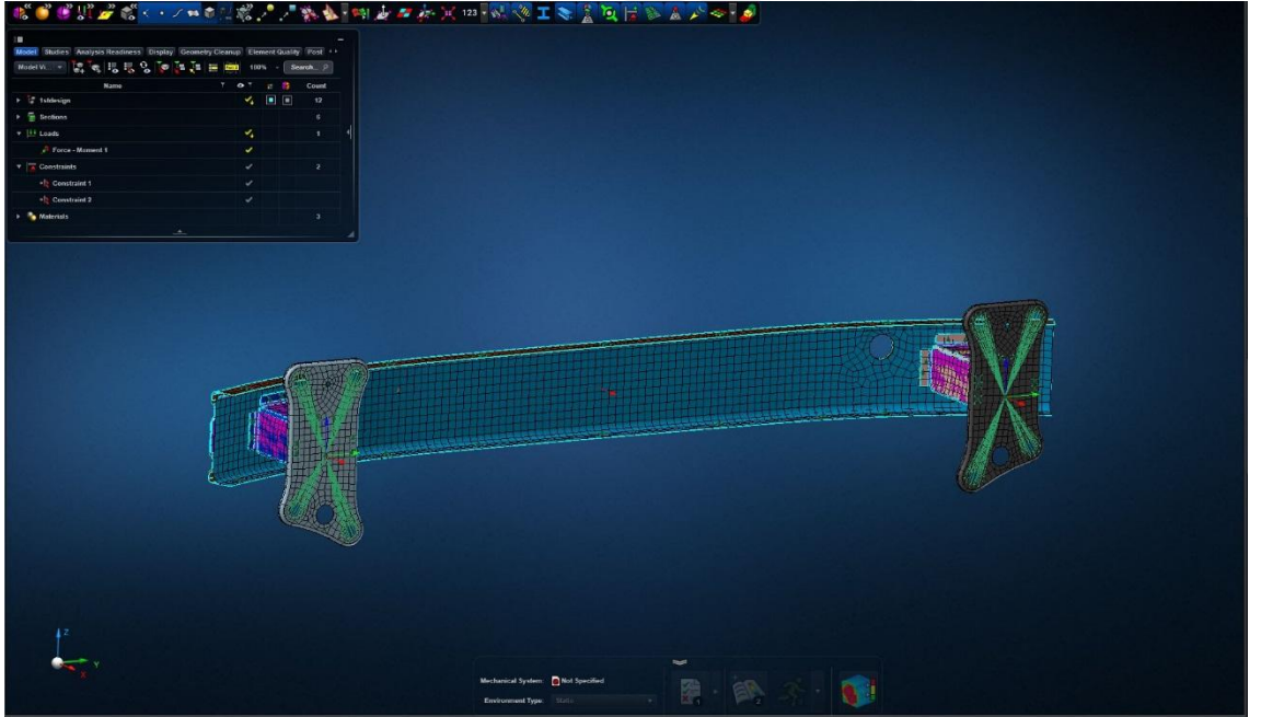
Şekil 3.8. Ön Tampon Tasarımlarının Sonlu Elemanlar Modelindeki Sabitleme Noktaları
