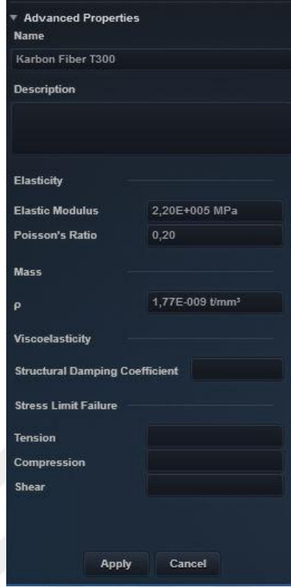
Şekil 3.3. MSC Apex Sonlu Elemanlar Modeli T300 Karbon Fiber Malzeme Değerler
