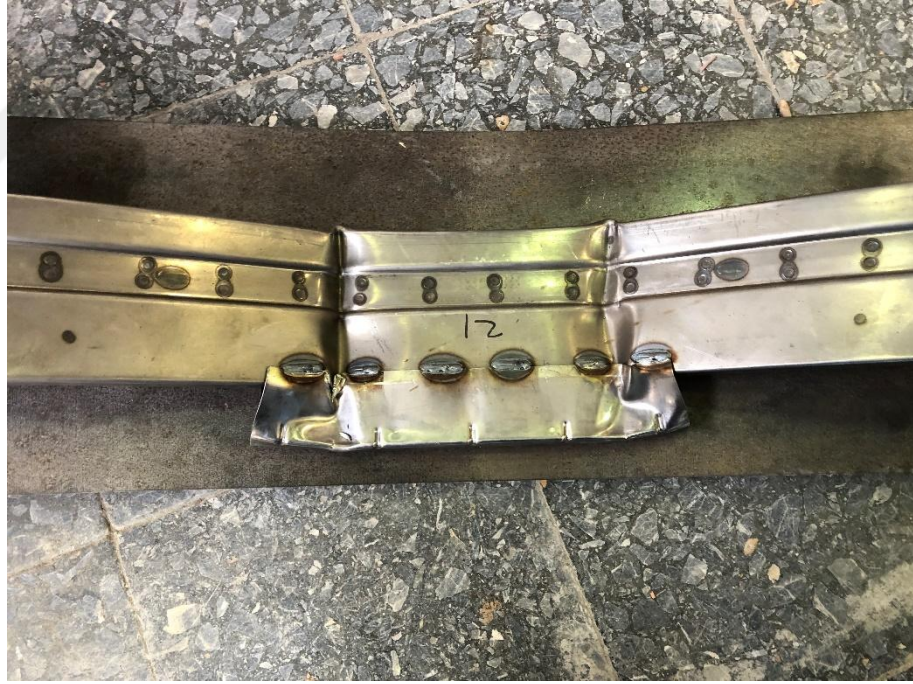
Şekil 3.51. Ön Tampon Tasarımının Test Sonucu
