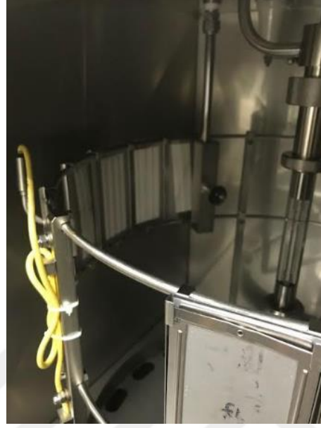
Şekil 3.5. İplik ve kumaş numunelerinin test kabini içindeki yerleşimi
