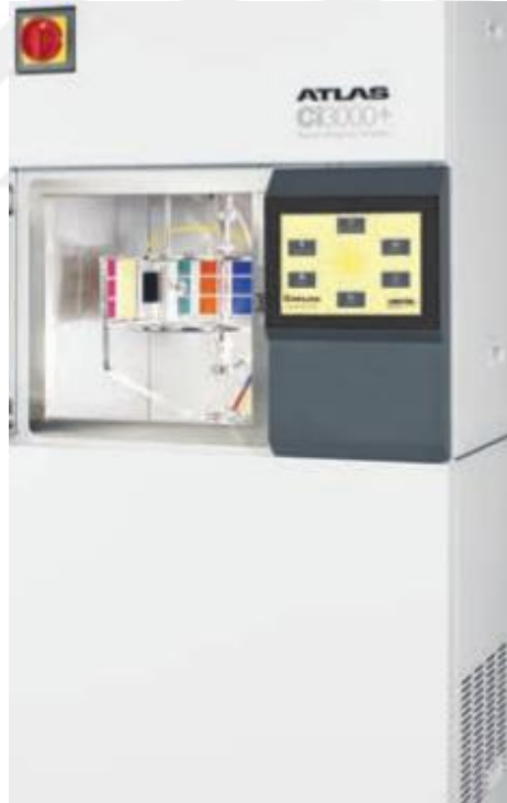
Şekil 3.3. Atlas Ci 3000+ weather-ometer test cihazı
