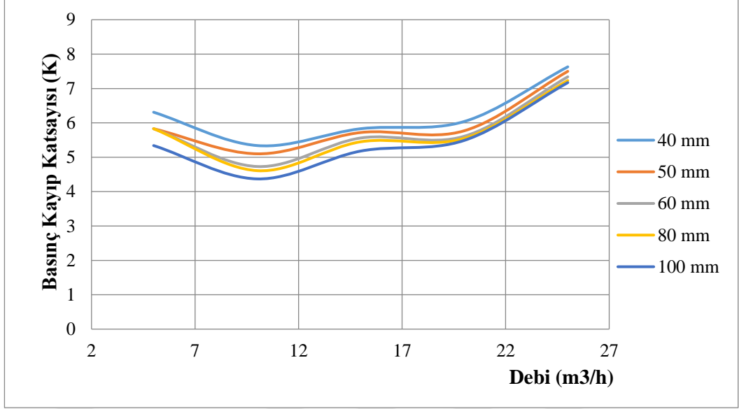
Şekil 4.19. Sanal gövde çapı değişimine bağlı olarak basınç kayıp katsayısı değişimi (D 2 =15 mm, D= 60 mm)
