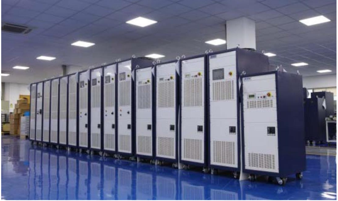
Şekil 2.12. Farklı kapasitelere sahip sarsıcılar için güç yükseltici örnekleri
