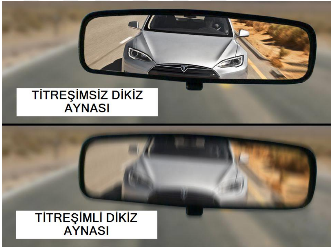
Şekil 3.1. Titreşimsiz – Titreşimli Araç İçi Dikiz Aynası
