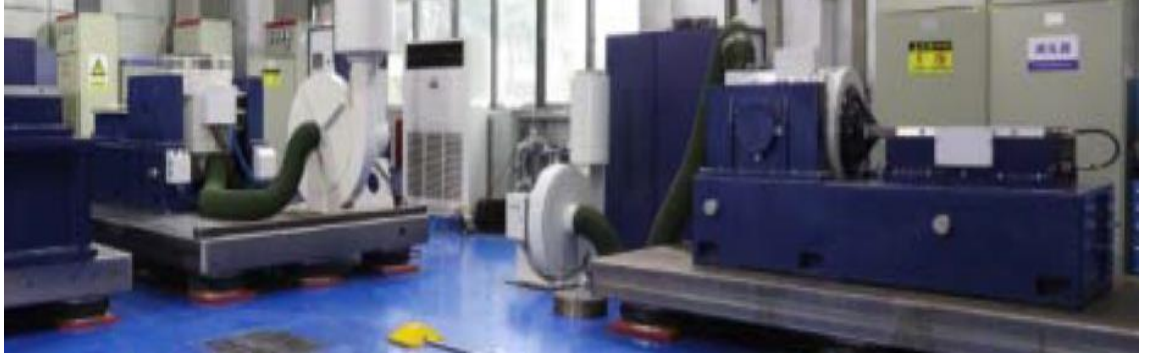
Şekil 2.10. Sarsıcılar için titreşim izolasyonu örneği
