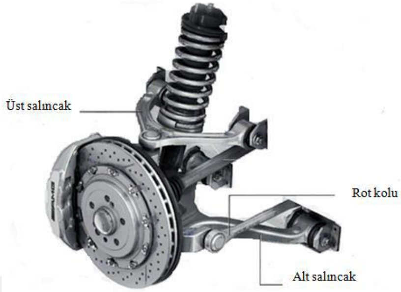
Şekil 2.4. Çift salıncaklı süspansiyonun parçaları (Putgül ve Altıparmak 2015)
