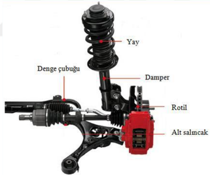
Şekil 2.5. Macpherson süspansiyonunun parçaları (Putgül ve Altıparmak 2015)
