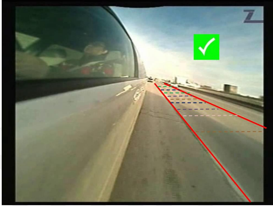
Şekil 3.11. Kör nokta uyarı sistemi-3 (Saboune ve ark. 2011)
