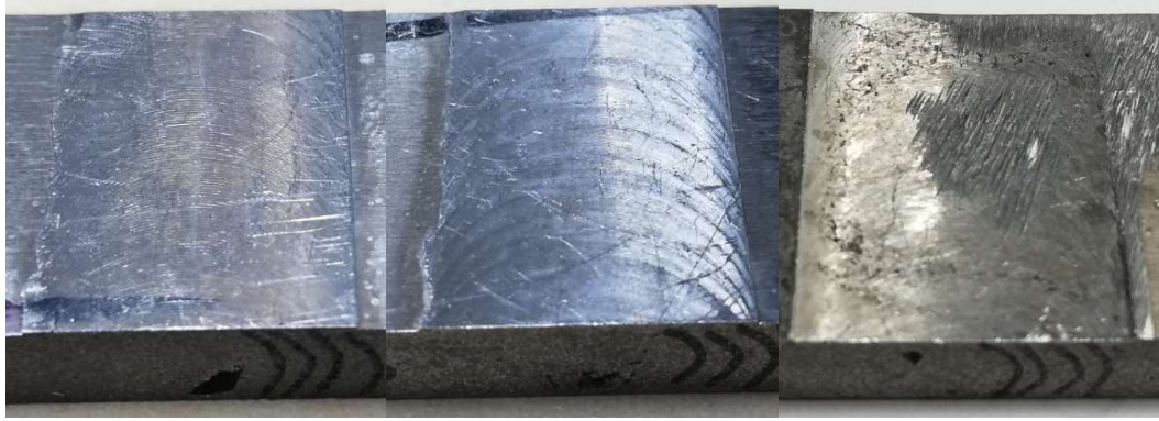
Şekil 4.2. Soldan sağa doğru 4-5-6. kaynaklar (1200 RPM 200-100-50 mm/dk).
