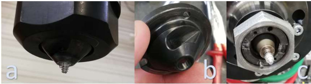
Şekil 2.7. Sabit omuzlu sürtünme karıştırma kaynağı ucu görselleri.
