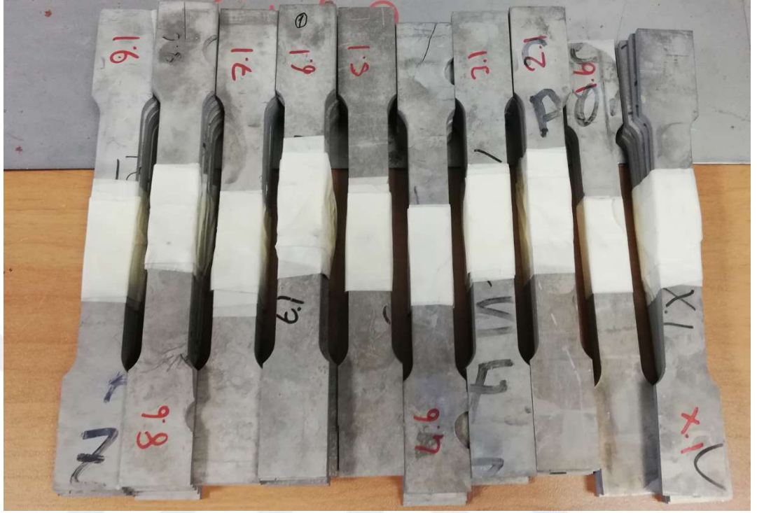
Şekil 3.14. Çekme numuneleri görseli.
