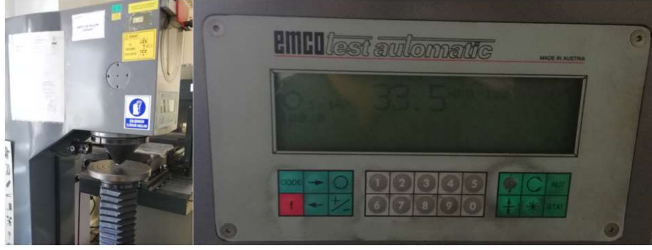
Şekil 3.16. Çekme numunelerinin, sertliklerinin ölçülmesi görseli.
