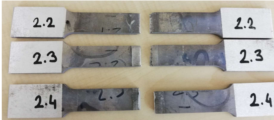
Şekil 4.25. Çekme işlemi sonrası parça görselleri.
