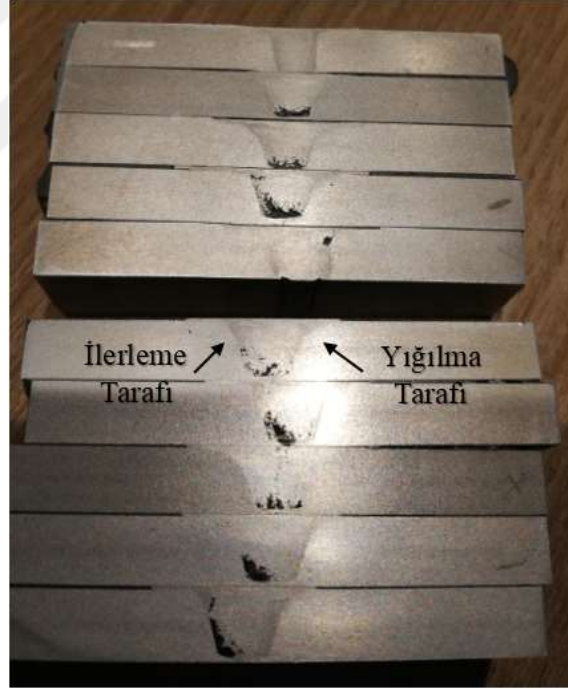
Şekil 3.12. Metalografi numunelerinin dađlama sonrası görselleri.
