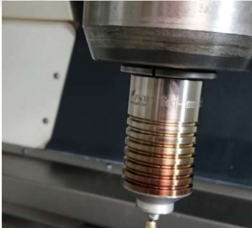
Şekil 3.3. SKK için kullanılan standart uç görseli.
