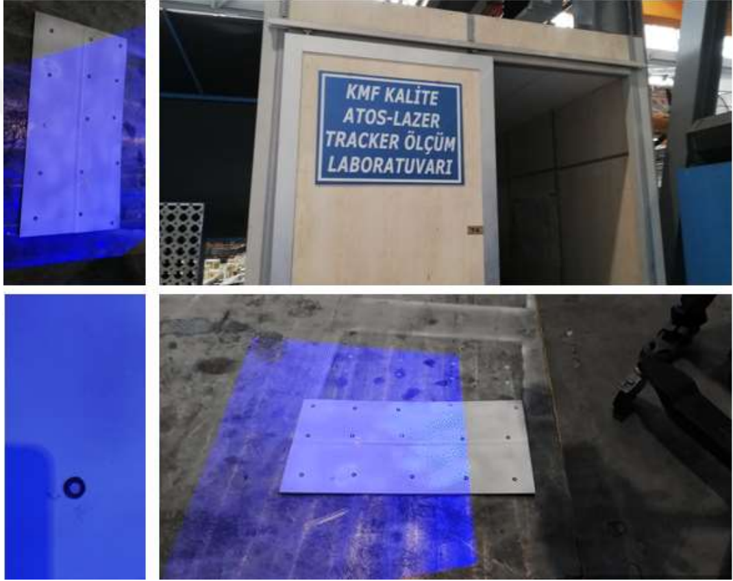
Şekil 4.30. ATOS cihazı ile yüzey tarama işleminin görüntüsü.
