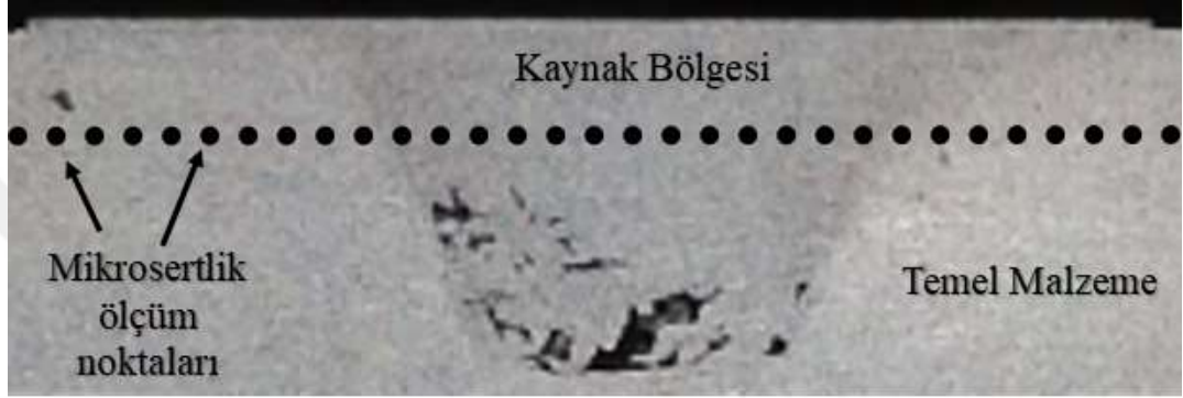
Şekil 3.18. Mikrosertlik ölçüm aralıklarının şematik gösterimi.
