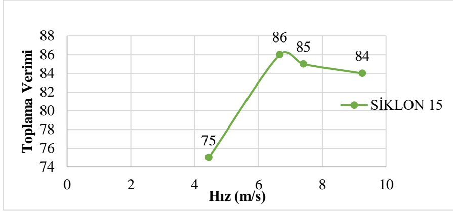
Şekil 4.32. Siklon 15 için hıza bağlı verim değerleri
