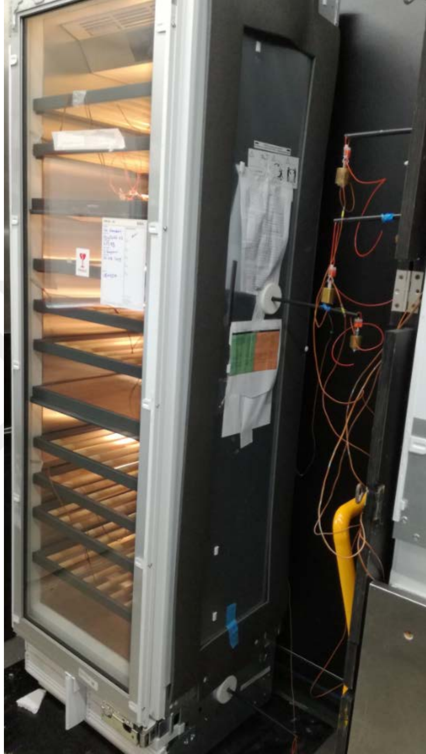
Şekil 3.32. US standardına göre test elemanları bağlantısı
