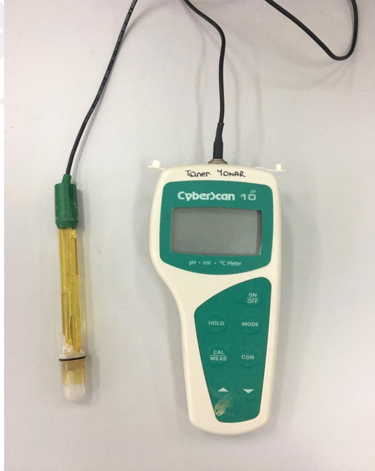
Şekil 3.5. Deneysel çalışmalarda kullanılan pH metre
