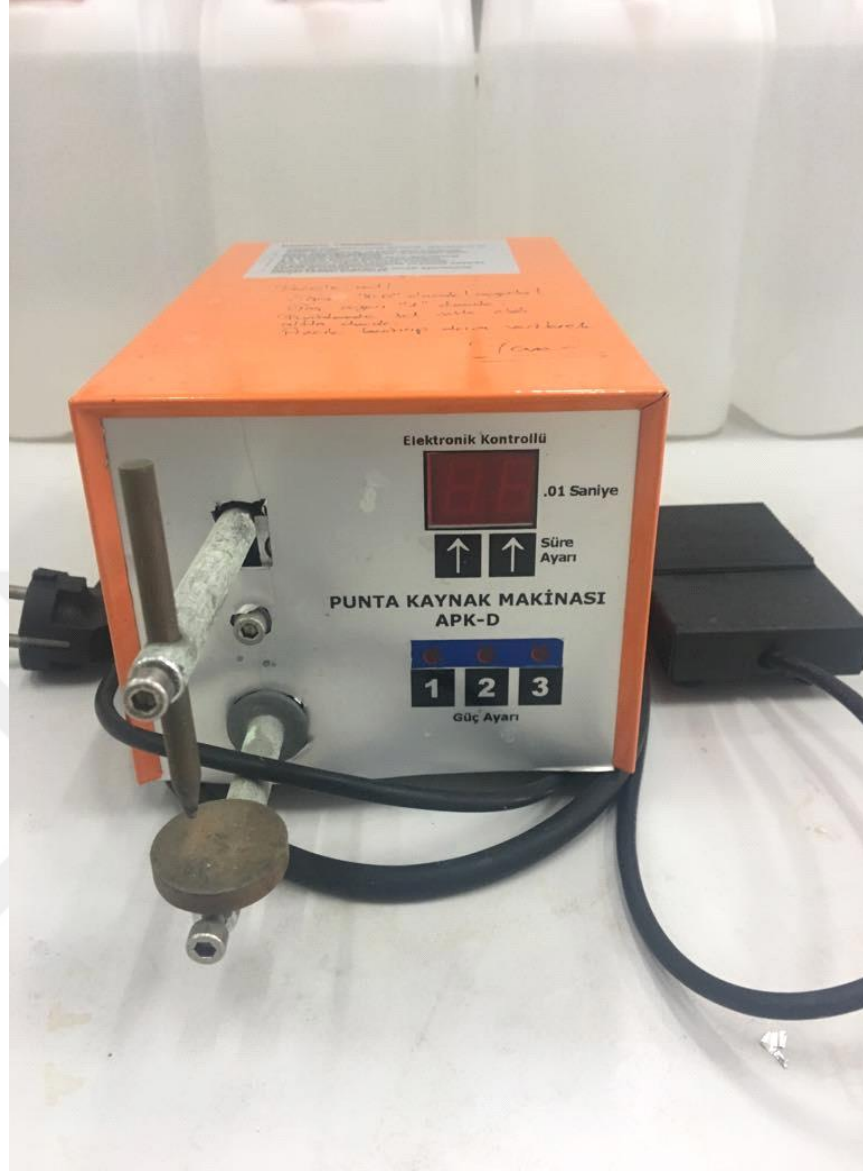
Şekil 3.7. Deneysel çalışmalarda kullanılan punto kaynak makinası
