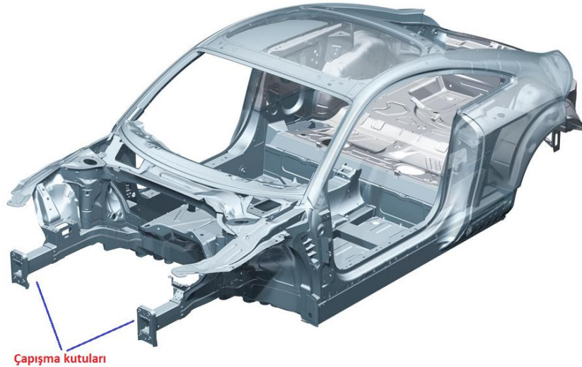
Şekil 1.2. Bir aracın iskelet yapısı ve çarpışma kutuları
