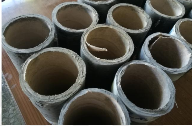
Şekil 3.19. Karton kalıp ile beraber kesilen numuneler
