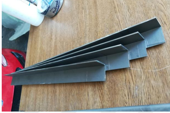
Şekil 3.13. Köşe kısımlara konulan L şeklindeki çelik saclar
