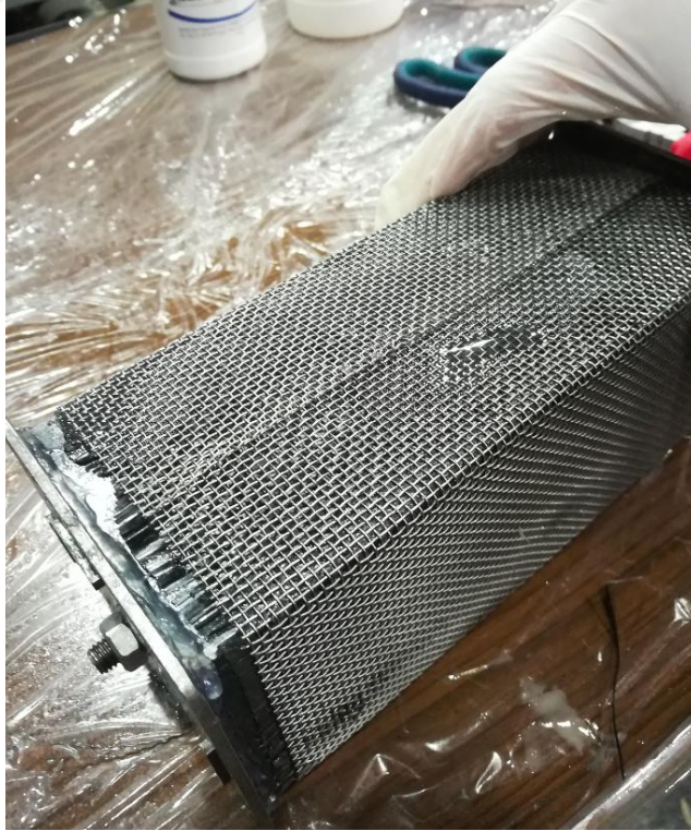
Şekil 3.9. Kalıp yüzeyine sarılan örgü tel takviye malzemesi
