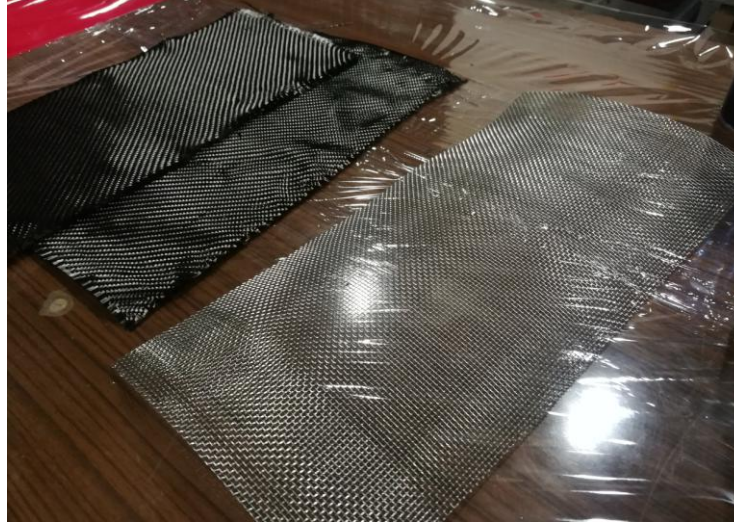
Şekil 3.8. Uygun ölçülerde kesilmiş karbon fiber ve çelik örgü tel malzemeleri
