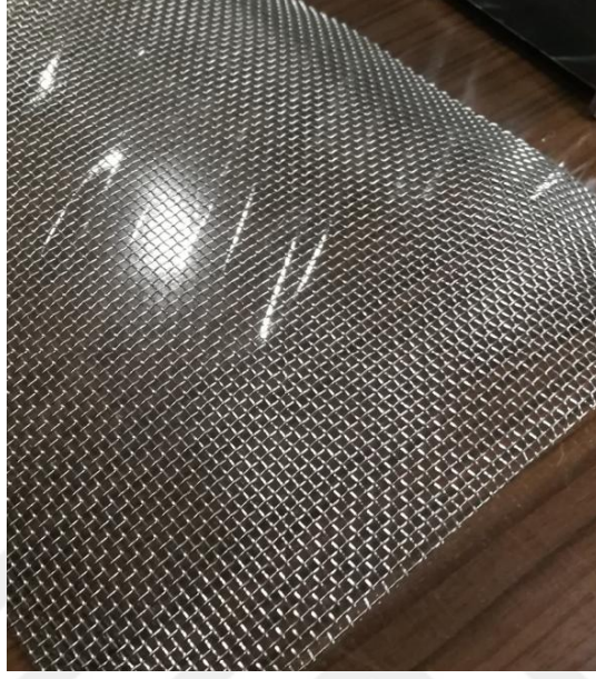
Şekil 3.5. Takviye malzemesi olarak kullanılan paslanmaz örgü tel
