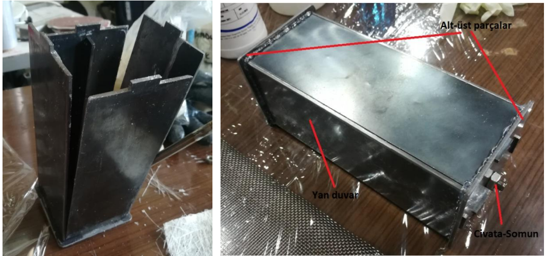
Şekil 3.6. Kare geometriye sahip kalıp
