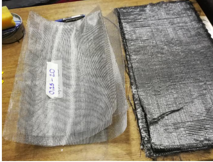
Şekil 3.17. Numeneler için kesilen çelik ve karbon fiber malzemeler
