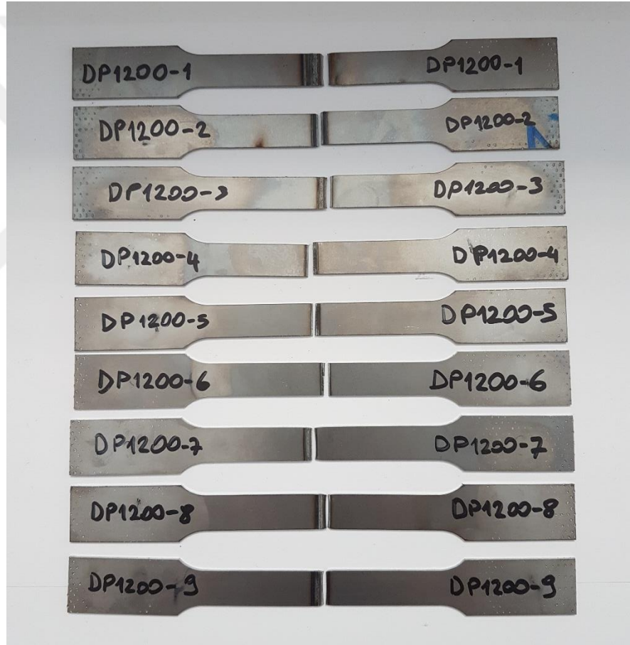
Şekil 4.111. Çekme testi sonucu kırılan kaynaklı numuneler
