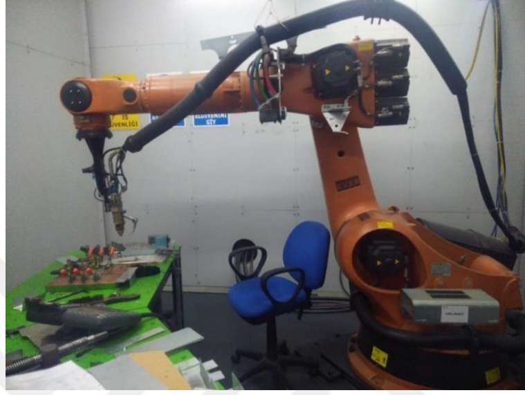
Şekil 3.3. Çalışmada kullanılan KUKA robot kollu fiber lazer kaynak cihazı
