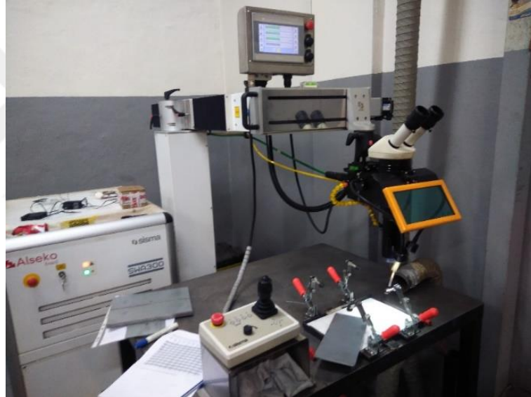
Şekil 3.1. Sisma SWA300 Nd:YAG lazer kaynak cihazı
