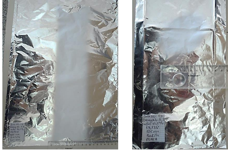
Şekil 3.4. Elektrospinning cihazından alınan Alüminyum folyo numuneleri (sol, silindir toplayıcı, sağ, plaka toplayıcı)
