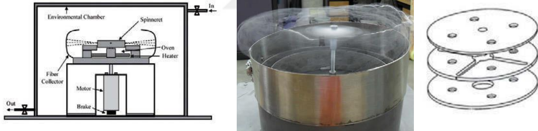
Şekil 2.11. Sistemin krokisi (sol), nano lif ağları (orta), örnek bir düze (sağ) (Sarkar ve ark. 2010'dan değiştirilerek alınmıştır)
