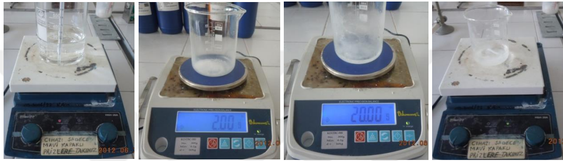
Şekil 3.1. Ağırlıkça %10'luk PVA - saf su çözeltisinin elde edilmesi için gereken aşamalar
