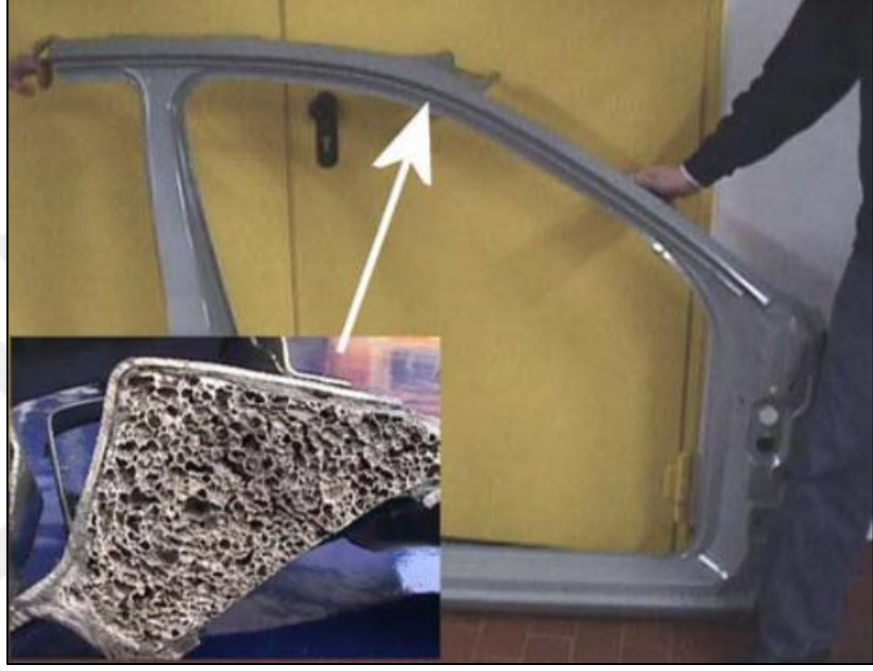
Şekil 3.7. Alüminyum köpüğün araç A-sütununa entegrasyonu (Stöbener ve ark. 2009)
