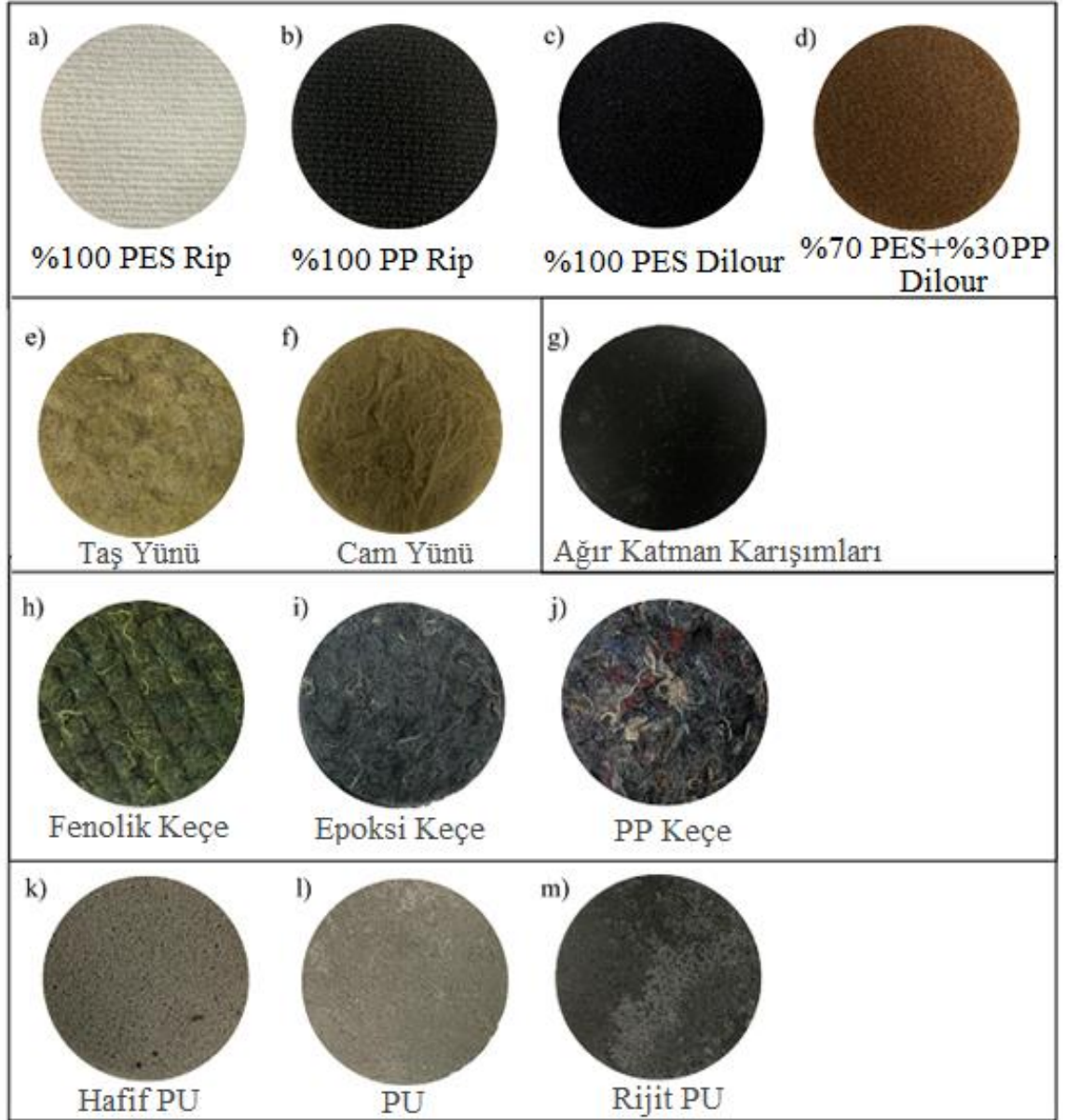
Şekil 3.6. Çalışmada kullanılan numunelere ait görseller
