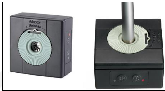
Şekil 2.10. Brüel&Kjær mikrofon kalibratörü (Anonim 2014)
