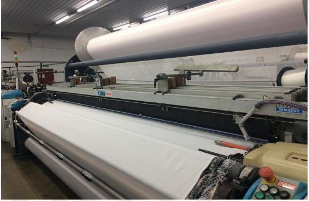
Şekil 3.2. Numune kumaşların üretildiği Vamatex armürlü dokuma makinesi
