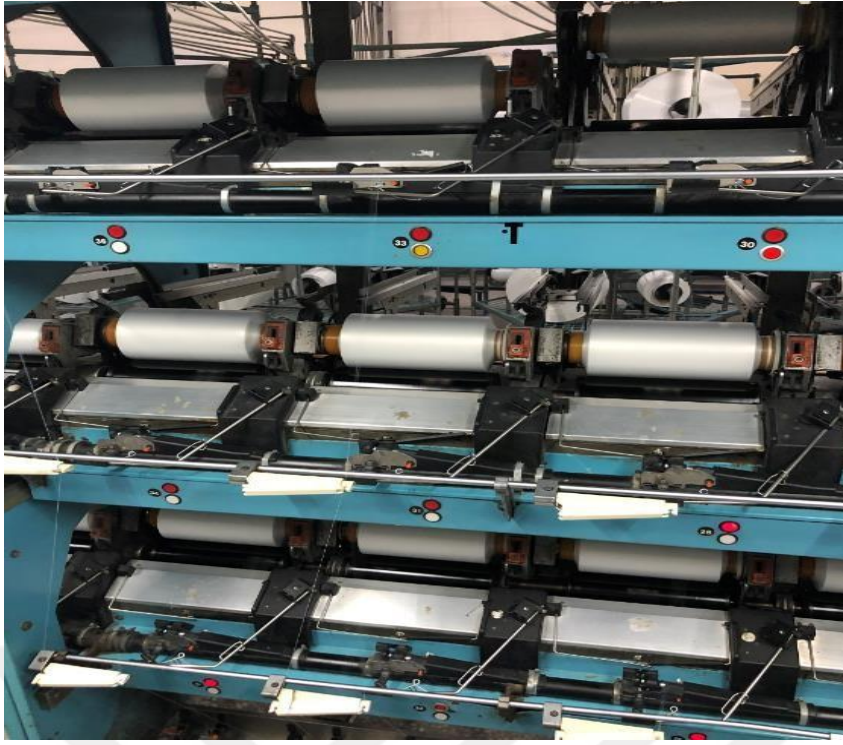
Şekil 2.9. Yalancı Büküm Tekstüre Makinası Sarım Ünitesi
