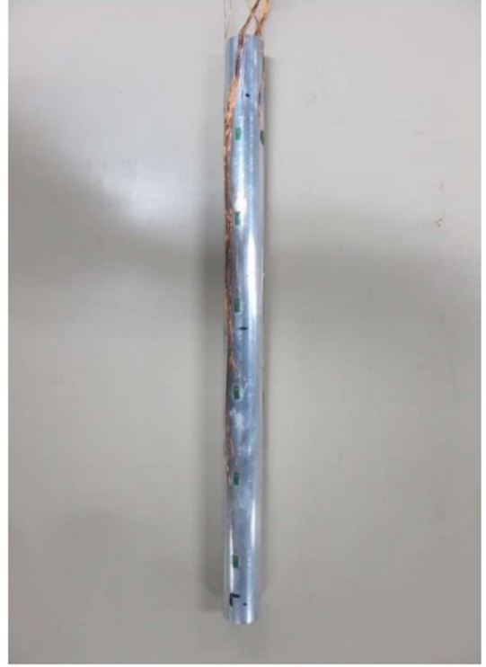
Şekil 3.1. Düşey ve kesme gerinim ölçü aygıtlarının yerleştirilmesi (Ünsever 2015)
