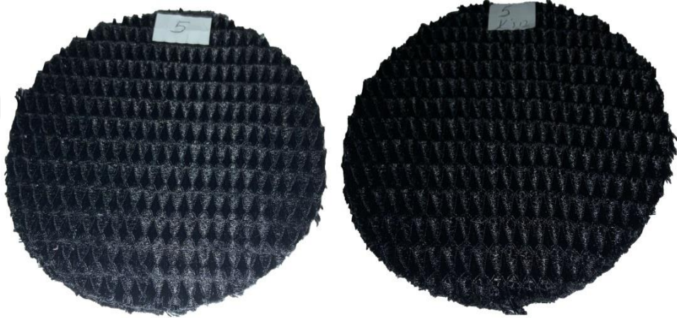
Şekil 3.29. 5 numaralı numuneden bir yüzü kaplamalı diğer yüzü kaplamasız ters kumaş
