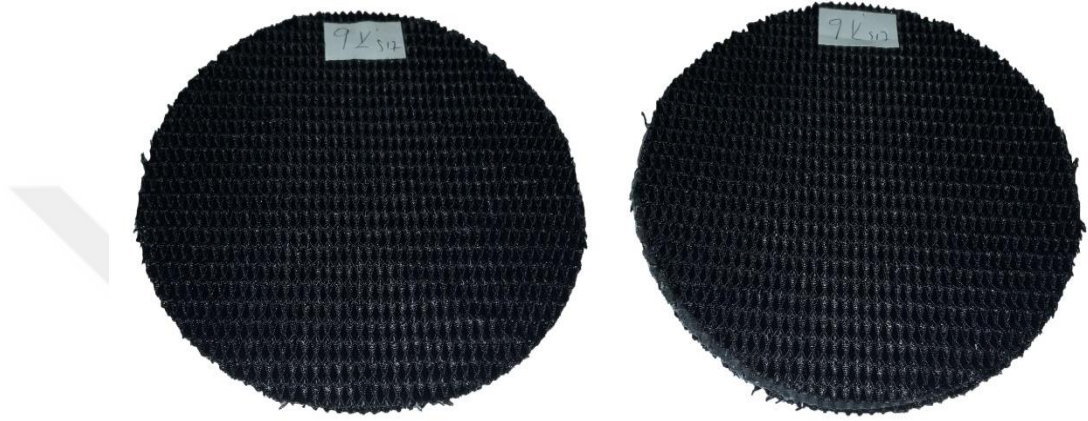
Şekil 3.33. 9 numaralı numuneden iki yüzü de kaplamasız düz kumaş
