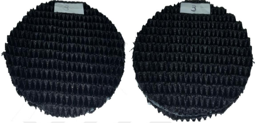
Şekil 3.21. 3 numaralı numuneden iki yüzü de kaplamalı düz kumaş
