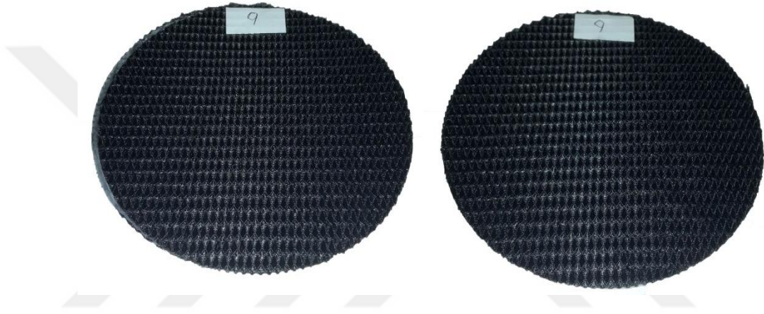
Şekil 3.36. 9 numaralı numuneden iki yüzü de kaplamalı ters kumaş
