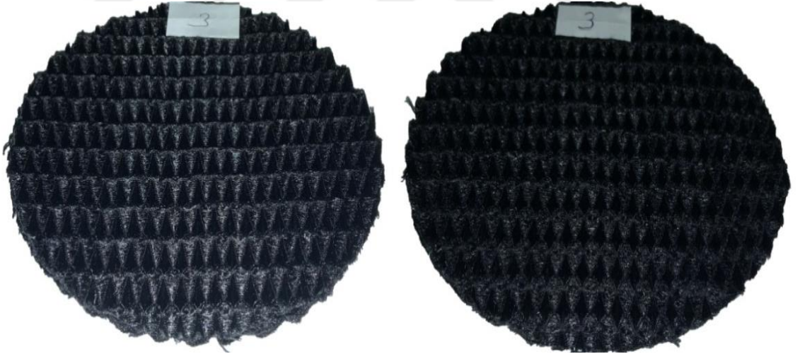
Şekil 3.22. 3 numaralı numuneden iki yüzü de kaplamalı ters kumaş
