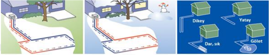
Şekil 3.7: Jeotermal Isı Pompasının Soğutma ve Isıtma Amaçlı Kullanımı ve Çeşitli Tesisat Konfigürasyonları (Duffield, 2003)
