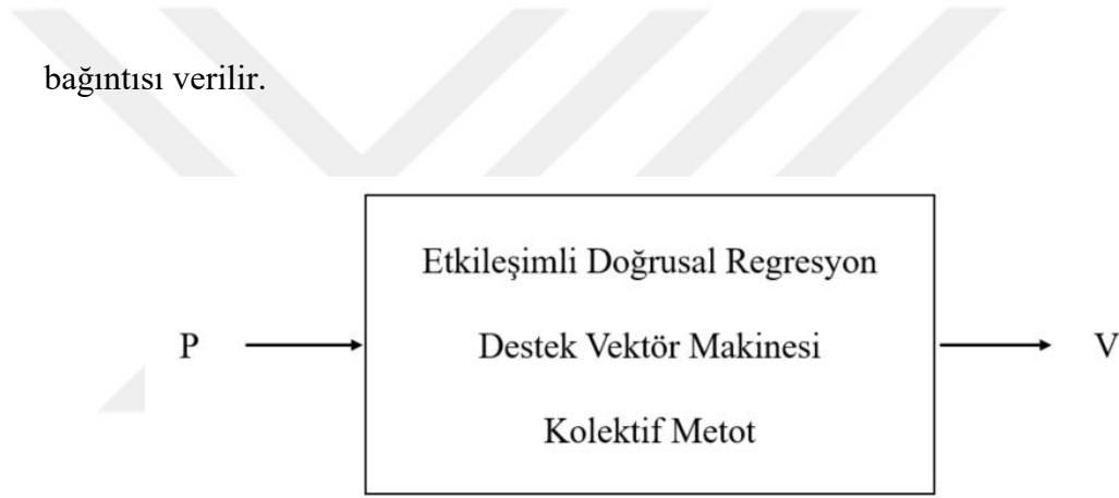
Şekil 3.13. Çalışmada seçilen makine öğrenmesi modellerinin blok gösterimi
