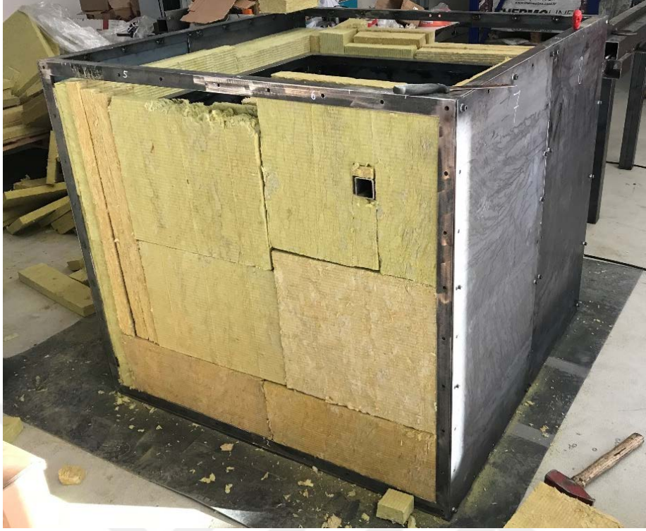
Şekil 4. 8. Titreşim Test Düzeneği Taş Yünü Dolgusu
