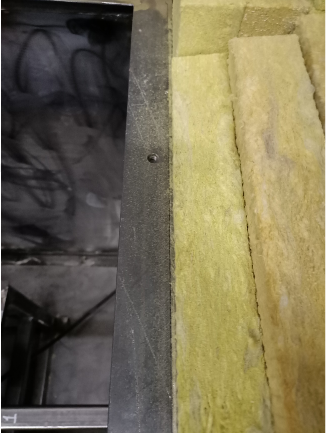
Şekil 4. 16. Yorulma Testi Sonrası Taş Yünü Malzemesi
