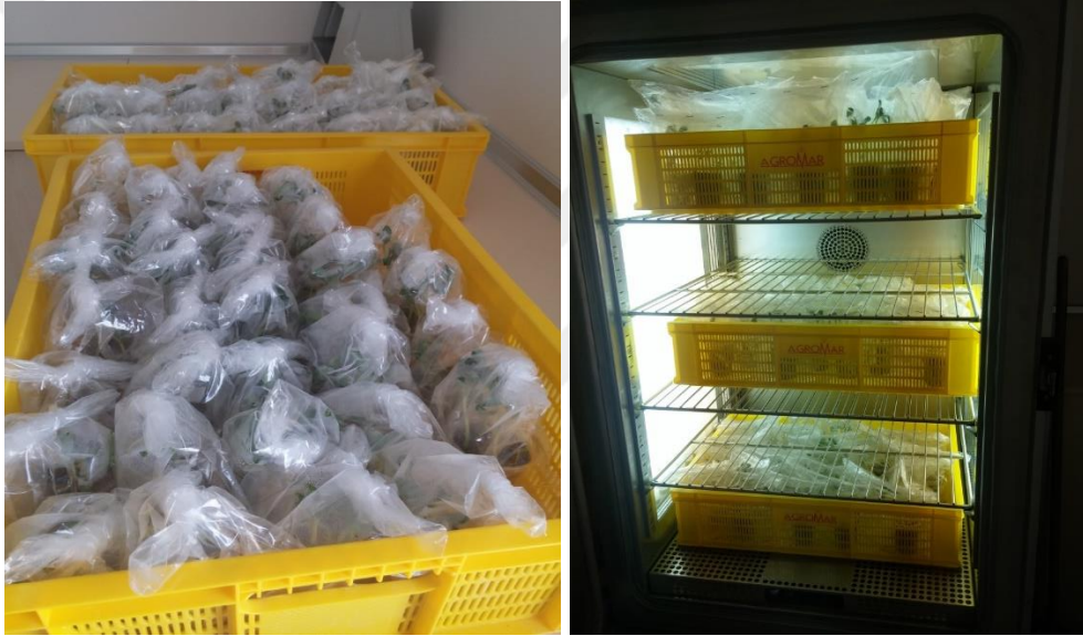
Şekil 3.5. %100 nem için bardakların poşetlere geçirilmesi
